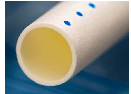
Künstliches Gefäß aus Polyurethan
