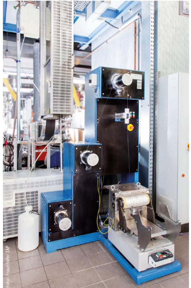
Abbildung 2: Fourné-Schmelzspinnanlage
