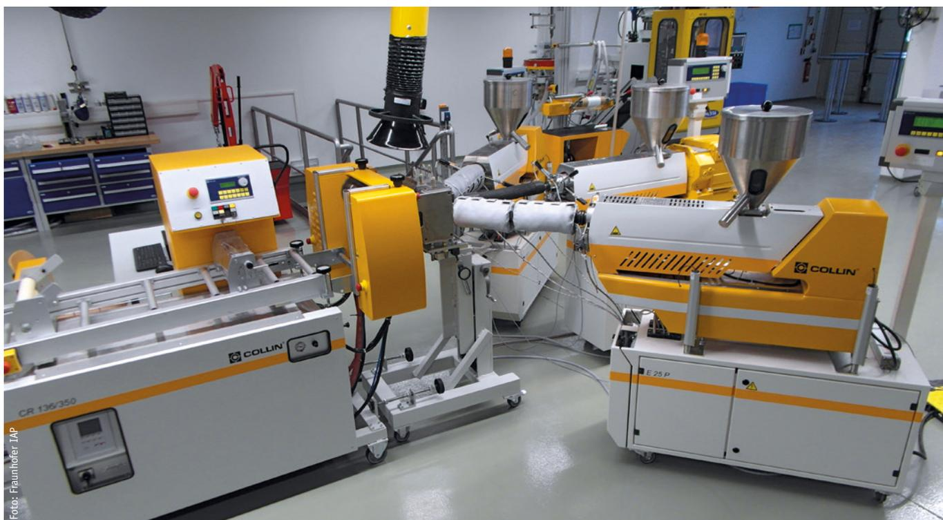
**Abbildung 1: Drei-Schicht-Folienextrusionsanlage**
