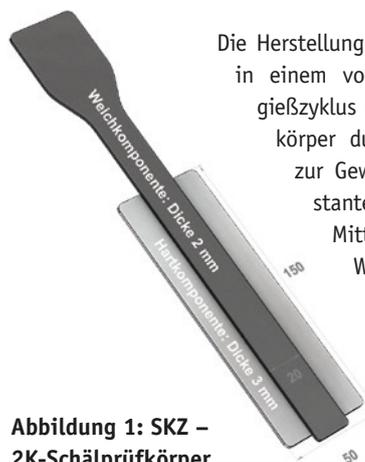
Die Herstellung der Prüfkörper erfolgte in einem vollautomatischen Spritzgießzyklus mit Entnahme der Prüfkörper durch ein Handlinggerät zur Gewährleistung eines konstanten Spritzgießprozesses. Mittels einer umfassenden Werkzeugsensorik und einem Inline-Thermografie-System konnte eine hohe Prozesskonstanz und Reproduzierbarkeit sichergestellt werden.
