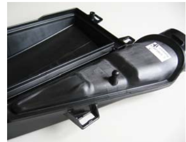
Abbildung 7.6.2.2.1: Luftfilter im Motorraum des M157 DELA55 BiTurbo (Quelle: Daimler)
