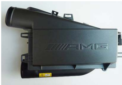
Abbildung 7.6.2.2.2: Lackiertes linkes Luftfiltergehäuse aus Akulon (Quelle: Daimler)
