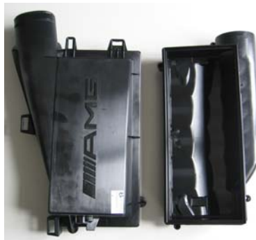
Abbildung 7.6.2.2.3: Links unlackierte Reinlufthaube, rechts Rohluftgehäuse (Quelle: Mann+Hummel)
