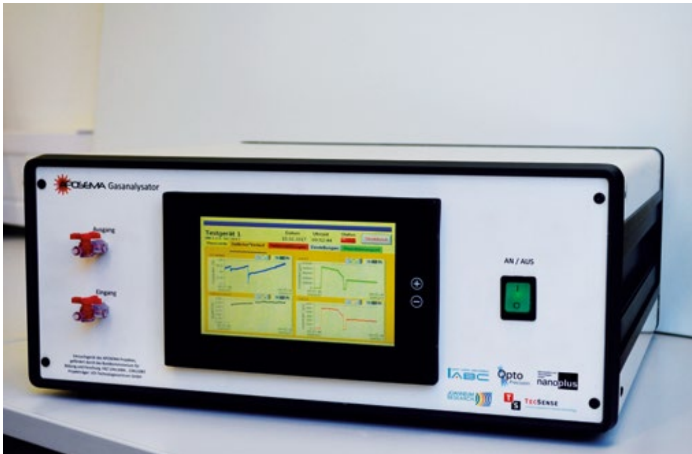
Der Prototyp des laserbasierten Atemgasanalysators aus dem EU-Projekt APOSEMA wird aktuell am Mausmodell getestet. Foto: IABC
