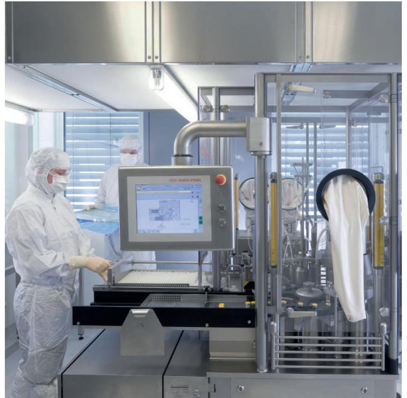
Dieser Teil der GMP-Anlage (Good Manufacturing Practice) von CureVac ist die Abfüllanlage mit der höchsten Reinraumklasse A. (Foto: CureVac GmbH)
